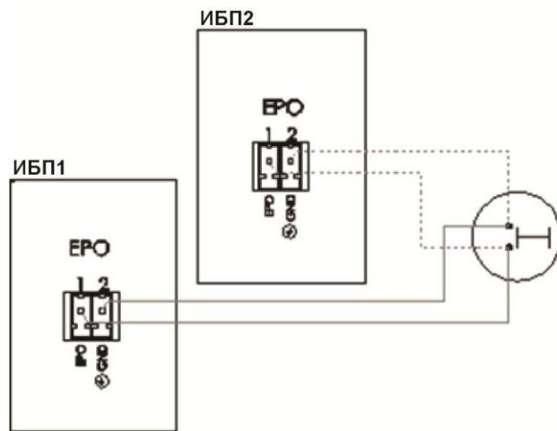
Соединение между выключателем аварийного отключения и портом ИБП:
