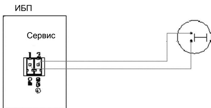
Соединение между опережающим контактом внешнего сервисного выключателя байпас и сервисным портом ИБП:
