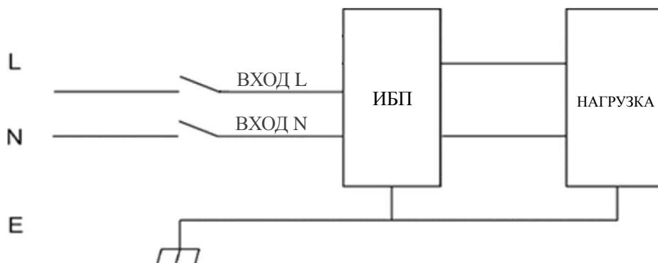
Схема соединения на входе — «однофазная с заземлением».
