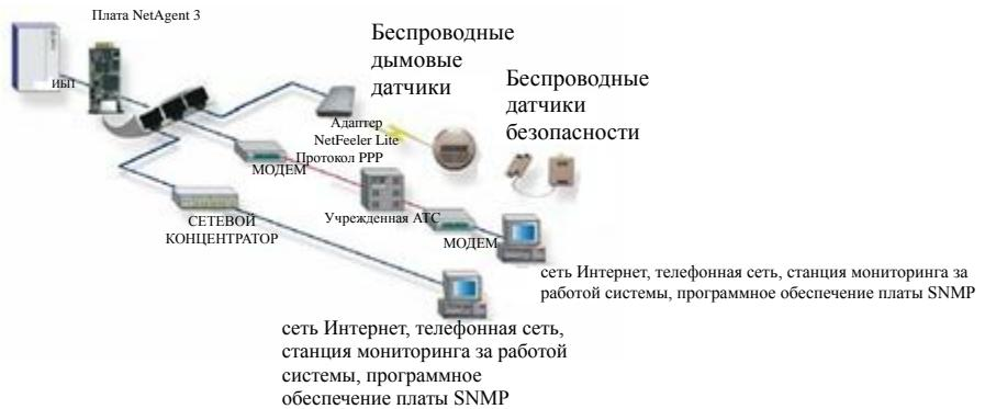
Стандартная топология сетевого управления ИБП
