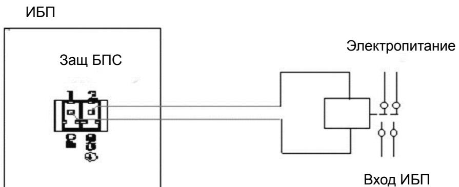
Соединение между внешним устройством и портом защиты от обратных токов ИБП:
