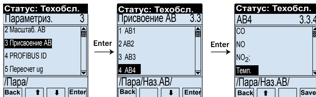
Рис. 81: Назначение аналогового выхода АВ4
