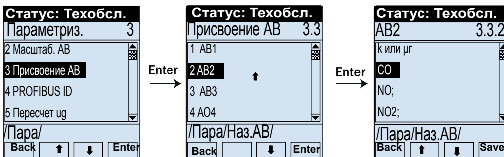
Рис. 80: Назначение аналогового выхода АВ3
