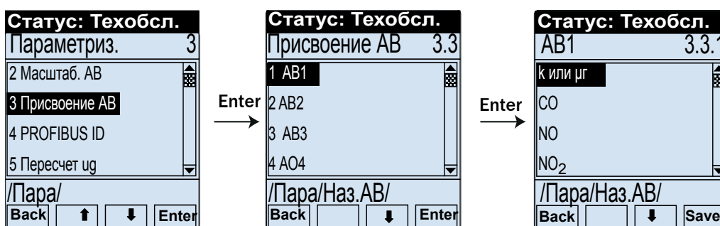
Рис. 79: Назначение аналогового выхода АВ2
