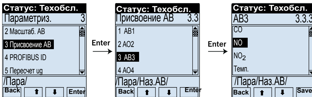
Рис. 80: Назначение аналогового выхода АВ3
